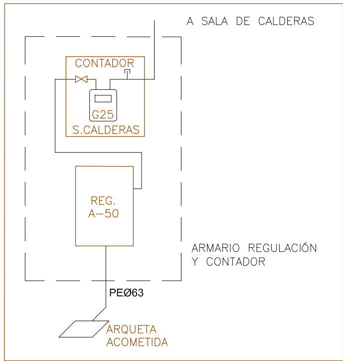
ESQUEMA INSTALACIÓN DE GAS SALA CALDERAS
